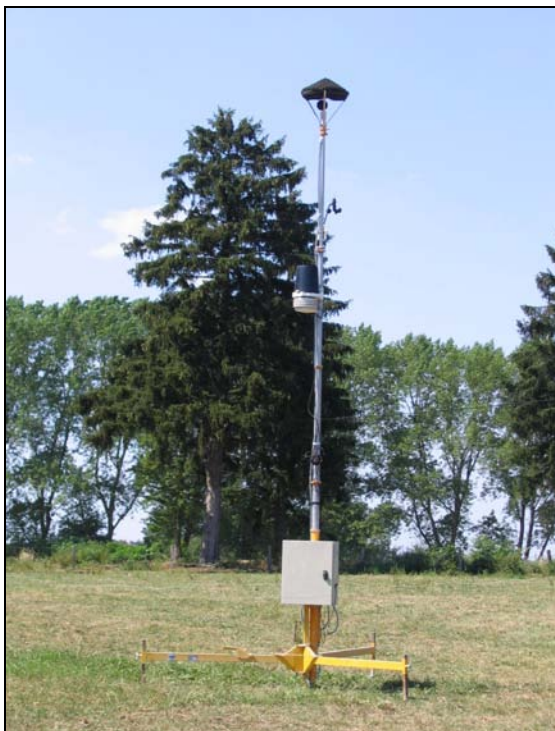
Figure 6-3 : Photo du mât acoustique avec station météo
