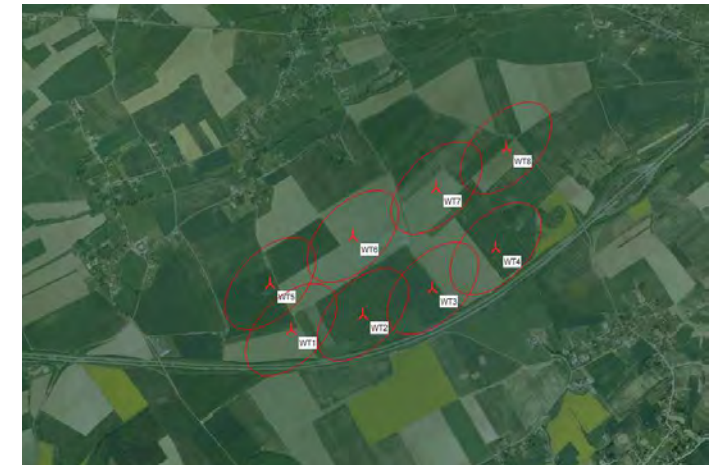
Figure 5: Configuration du parc éolien et cercles indiquant la distance correspondant à 7 fois le diamètre du rotor dans la direction des vents dominants
