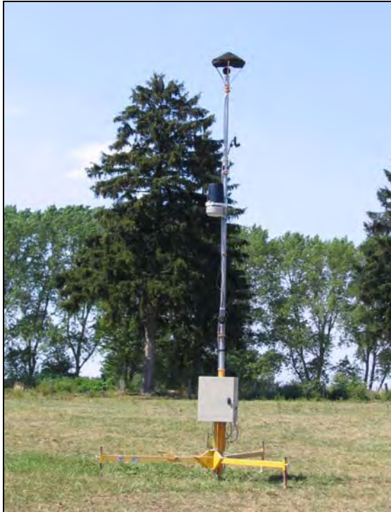
Figure 6-3 : Photo d'un mât acoustique avec station météo
